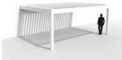
*Apoyada a una pared exterior: el marco se coloca con uno o dos lados contra una construcción o estructura de soporte subyacente. Las columnas verticales soportan la otra parte. Las lamas se pueden colocar paralelas o perpendiculares a la estructura de soporte.*
