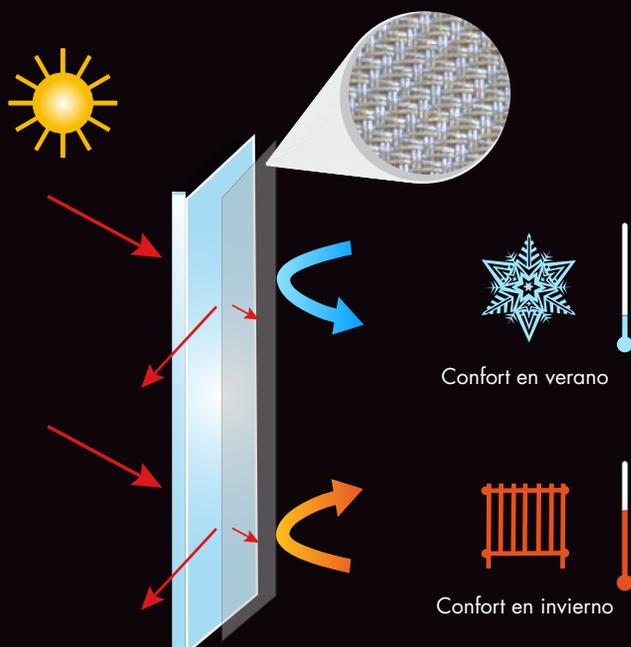
La emisividad de un material es su capacidad de emitir la energía recibida por efecto de conducción (calor / frío).
